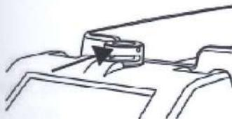
Nakon što glavu zatvarača pogurnete unatrag nakon umetanja cijevi (vidjeti korak 2 u poglavlju 0) te je otpustite, zatvarač će se promijeniti iz otvorenog u blokirano stanje. Ovako se olakšava rukovanje jer se omogućuje korisniku da odmah osjeti je li cijev ispravno blokirana u položaju.
